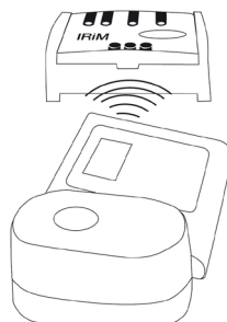
Encoche pour IR transmission de données
