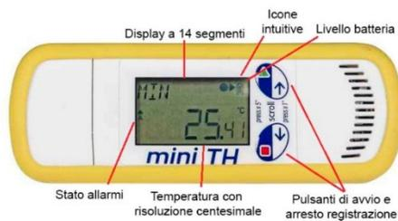
Figura 29: Interfaccia del dispositivo
