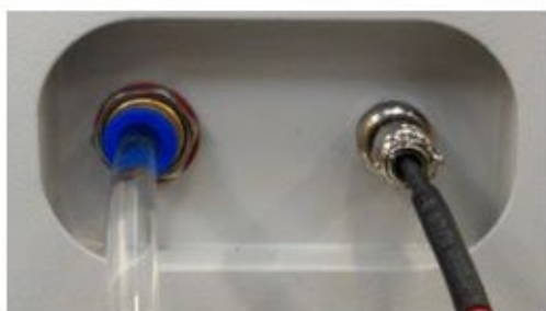
Figura 2 – Attacchi acqua di alimentazione
