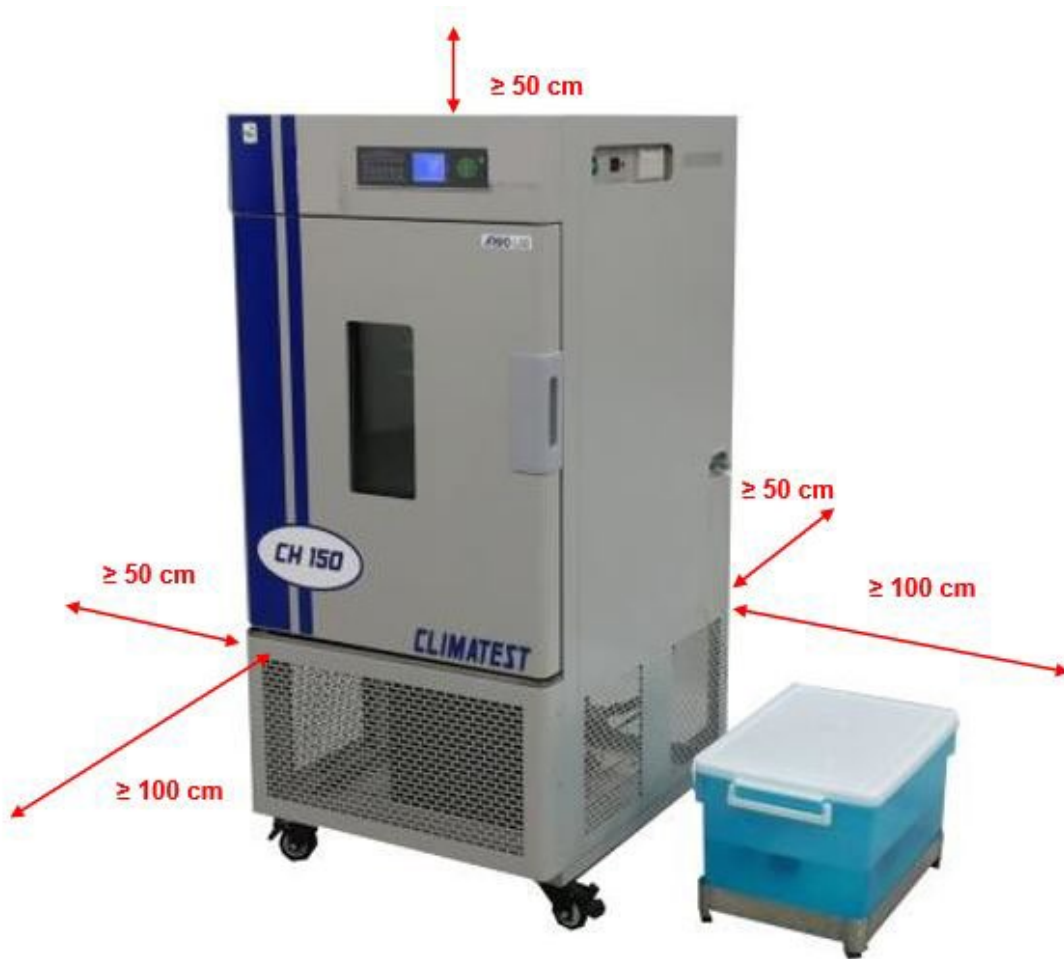
Figura 1 – Posizionamento dello strumento e della vasca di alimentazione
