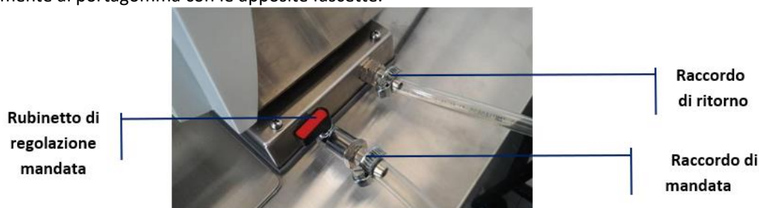
Figura 8 – Attacchi idraulici per ricircolo esterno
