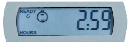
Partenza ritardata tramite magnete
